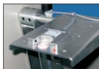
Yarn break or traveller jump sensor. Датчик обрыва/схода нити или соскока бегунка.
