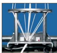
Covering device. Датчик объемного контроля технологического процесса покрытия нитей.
