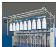
Doffing device (only in models PR300, PR360, PR375, PR500, CRG300, CRG375 and CRG450). Экстрактор катушек (только модели PR300, PR375, CRG300, CRG375, CRG450).
