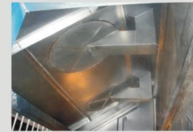
旋转滤网吸毛组件：采用旋转滤网自动吸毛装置，用气吸方式自动清理滤网上的棉尘。 Automatic rotary lint clean system
