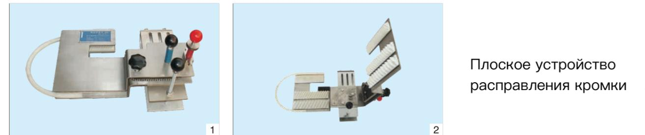
Плоское устройство расправления кромки
