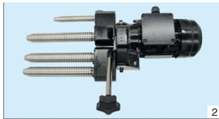
Устройство расправления кромки с четырьмя пальцами
