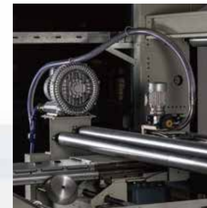
Устройство обрезки и выгрузки кромок Edge cutting and discharging device
