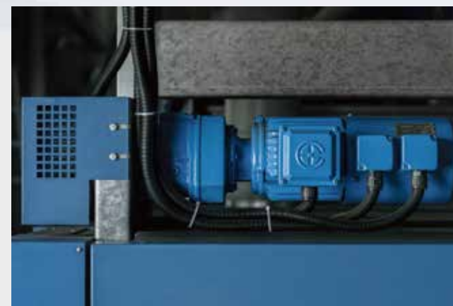
Двигатель настройки ширины. Прямой двигатель, положение выходного сигнала Width adjusting motor Direct motor coder, position output
