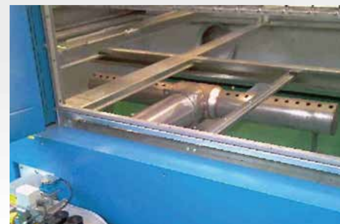
Прямой газовый обогрев Gas direct heating
