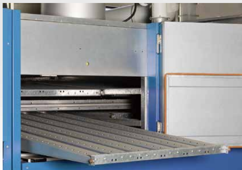
Выдвижная пластина с соплам Drawer-type nozzle
