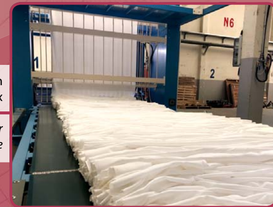
Accumulatore a nastro con funzione relax Relaxing conveyor belt for fabric storage
