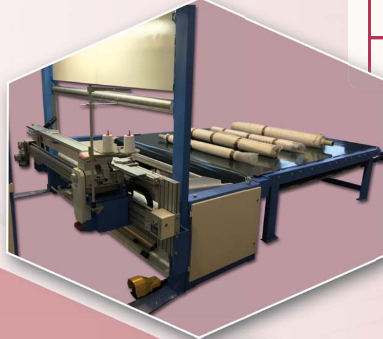
Alimentazione automatica rotoli Automatic roll's handling
