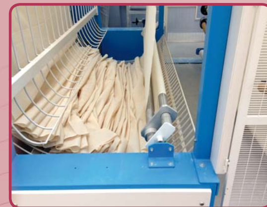
J-Box di accumulo tessuto J-Scray for fabric storage
