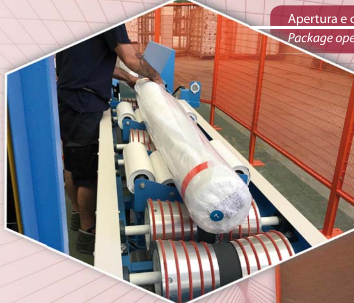
Alimentazione automatica rotoli Automatic roll's handling
