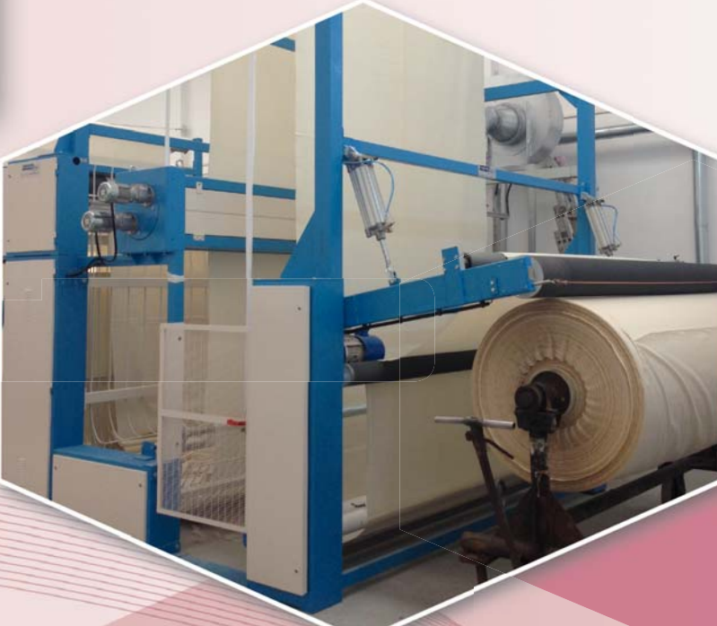
Arrotolatore tangenziale Tangential upwinder
