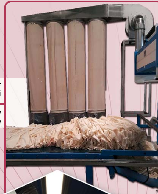
Gruppo aspirazione / filtrazione polveri Dust suctioning / filtering
