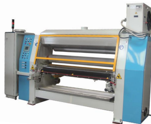
Блок трансфертной печати HotMelt для изготовления модных тканей
